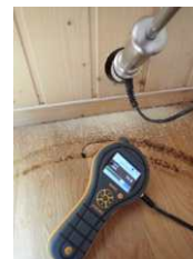
Fuktmåling i utlektet vegg på kjellerstue
