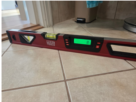
Måling av fall på gulv.
